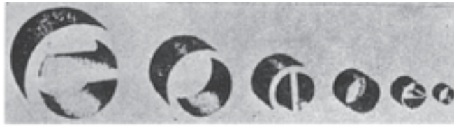
الف - حلقه‌های راشیگ و سینگ سرامیکی و فلزی در اندازه‌های مختلف
